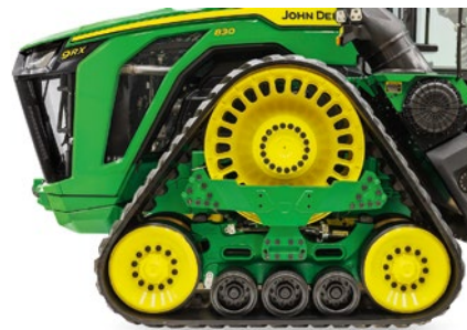
A 9RX 830 járószervezetének egy tagja a négyből („JOHN DEERE 9RX SERIE TREKKERS MET VEEL VERMOGEN EN VIER RUPS BANDEN” - TREKKERWEB.NL/ARTIKEL)
