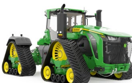
A megnövelt futófelületeknek köszönhetően a talajnyomás megegyezik a korábbi, kisebb modellekre jellemző 0,58 kg/cm 2 értékkel (TRACTEUR 9RX 770 DC7 - MUNGFALI.COM)
