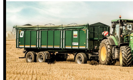
Háromtengelyes, forgószámolyos, három oldalra billentő pótkocsi.
