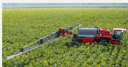
A Horsch Leeb 6.300 VL nyomtávja és hasmagassága is állítható
