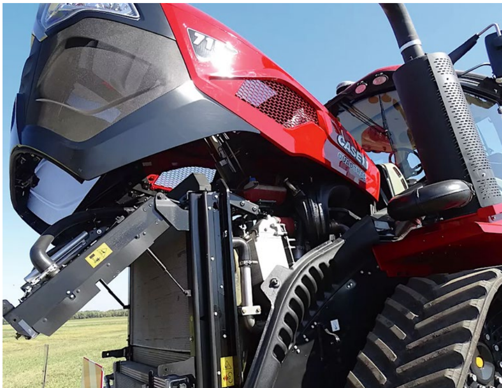
A motorburkolat felnyitásával könnyen hozzáférhetők a karbantartási pontok („CASE IH: QUADTRAC 715, IL NUOVO QUADRICINGOLO AI VERTICI DELLA POTENZA E DELLA CAPACITÀ OPERATIVA” MECCAGRI)
