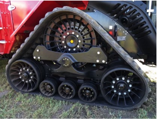
A megújult járószerkezet egyenletes súlyelosztást és minimális talajnyomást biztosít („CASE IH: QUADTRAC 715, IL NUOVO QUADRINGOLO AI VERTICI DELLA POTENZA E DELLA CAPACITÀ OPERATIVA” – MECCAGRI)
