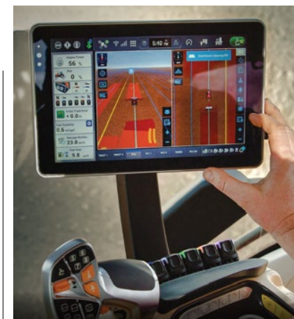
Az AFS Pro 700 kijelzővel és a főleg a jobb oldalon található kezelőszervekkel könnyen megy az irányítás
