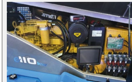
2. KÉP: Re-Gen: az iTARRA traktor energiaellátó rendszere (FORRÁS: „THE INSIDE TRACK ON THIS ROSCOMMON-DESIGNED DRIVERLESS TRACTOR”//YOUTUBE/AGRILAND)
