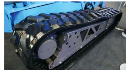
5. KÉP A jó tapadást és kedvező talajnyomást biztosító gumihevederes járószerkezet (FORRÁS: KEAVENEY: „AGRITECHNICA: ROSCOMMON MAN'S DRIVERLESS SMART TRACTOR STEALS SHOW IN GERMANY” / IRISH FARMERS JOURNAL ONLINE)
