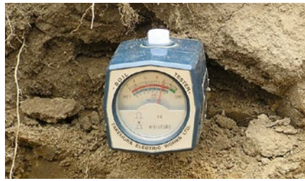
Analóg talaj pH- és nedvességmérő: közvetlenül a különböző talajrétegekben méri meg ezeket az értékeket (FOTÓ: PIXABAY)
