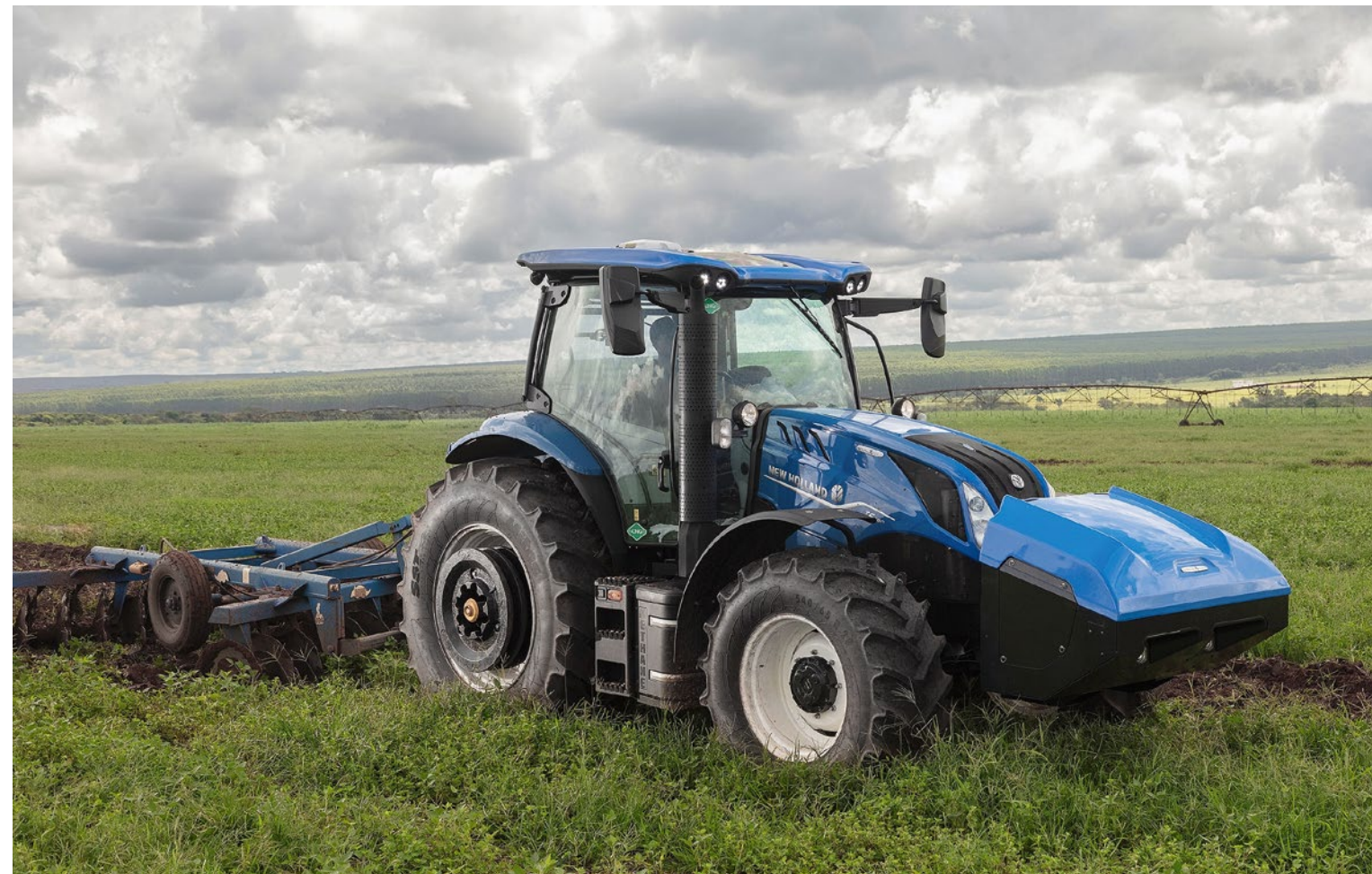
A T6.180 METHANE POWER TRAKTORÁNAK ERŐFORRÁSA AZ FPT INDUSTRIAL NEF67 FÖLDGÁZÜZEMŰ MOTORJA.
