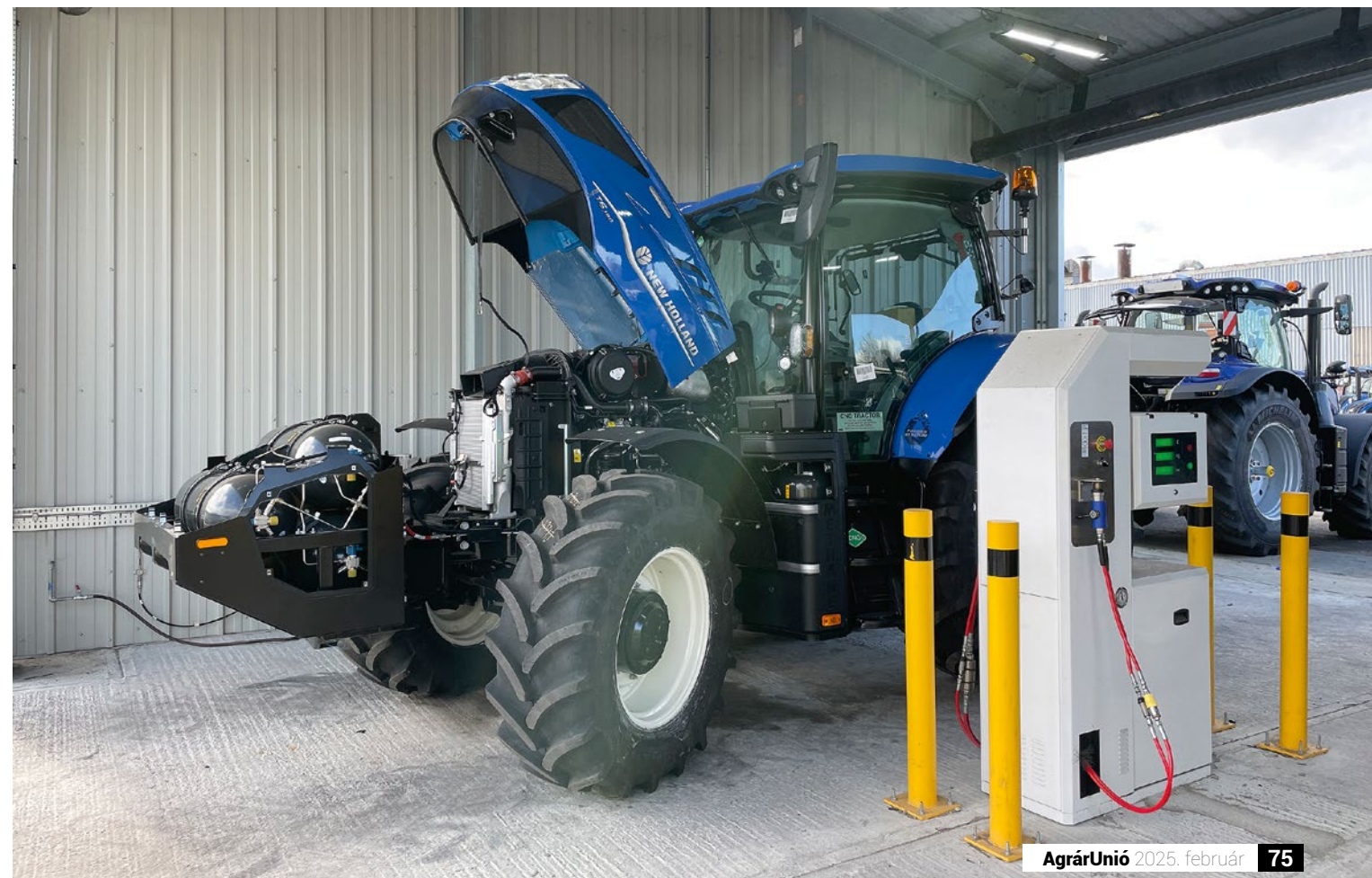
A T6.180 METHANE POWER TRAKTORÁNAK ERŐFORRÁSA AZ FPT INDUSTRIAL NEF67 FÖLDGÁZÜZEMŰ MOTORJA.
