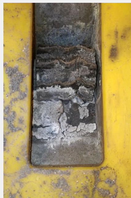
5. A rossz állapotú, vagy eltömődött adagolóberendezés miatt egész sorok maradhatnak védelem nélkül
