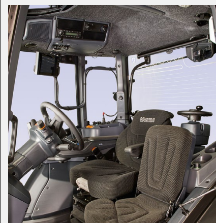
6,5 nm üvegfelület, 360 fokos körpanoráma szolgálja a rálátást a munkaterületre, az ülés pedig akár teljesen hátrafordítható
