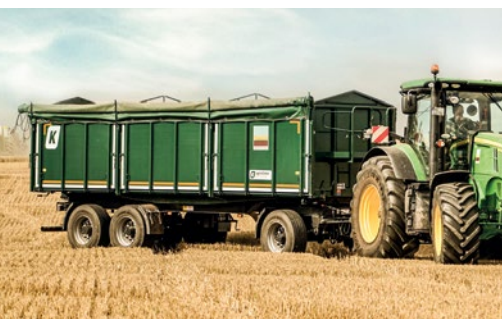
Háromtengelyes, forgószámolyos, három oldalra billentő pótkocsi.
