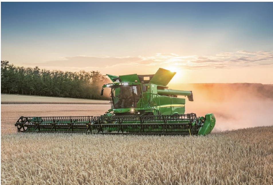
Az egyrotoros S típusok 75 t/h betakarítási teljesítményre képesek
