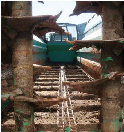
A SAMSON befogadóképessége alapkivitelben 15 köbméter, de oldalmagasítóval 20-ra növelhető. A rácsos homlokfalon a gépkezelő láthatja a trágyaszóró belsejét is
