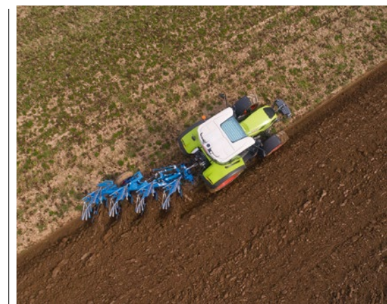
„Tarlónjáró” kivitelben az eke akár széles abroncsokkal szerelt traktorral is üzemeltethető
