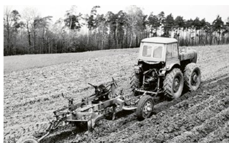
Vontatásra, akár terepre is alkalmas volt a Dutra, de sorművelésre nem
