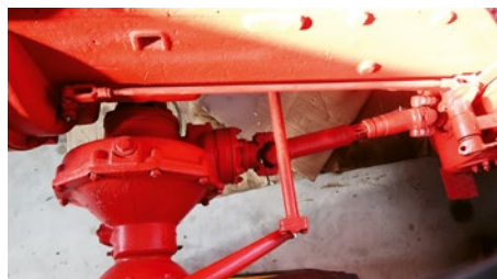
A Dutra traktorok egyik jellegzetessége az összkerekhajtás
