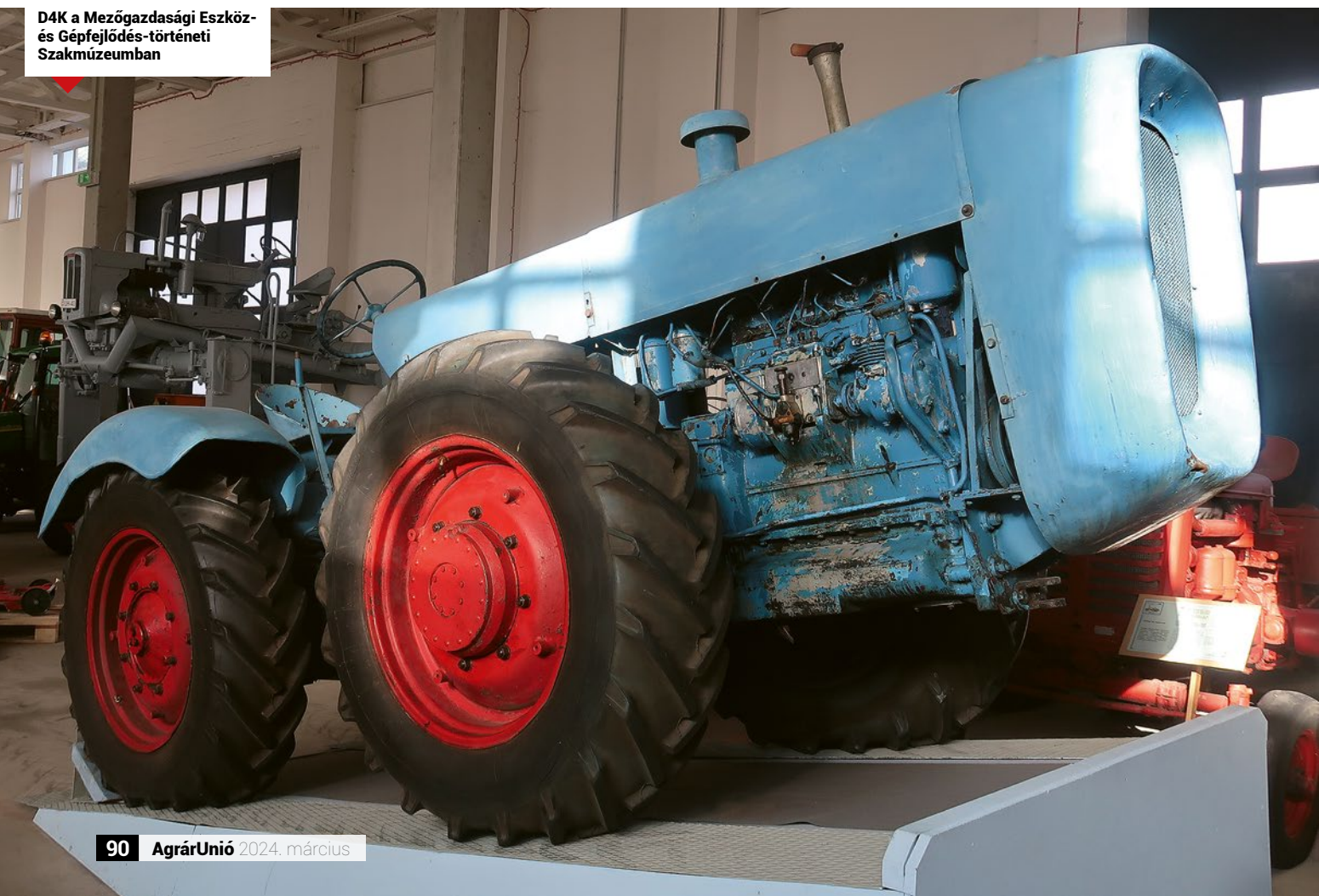
Tökéletesen restaurált, kicsi Dutra traktor, kéthengeres dízelmotorral
