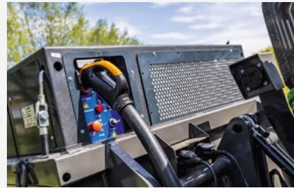
5. Az akkumulátorcsomag csatlakoztatása a traktorhoz (FORRÁS: FENDTFARMING.NL)
