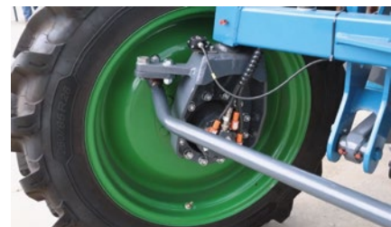
7. A kerekek hajtását 48 V-s hajtómotor végzi (FORRÁS: E-HORSE – BOESSENKOOL.COM)
